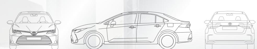
Alto\*: 1,455 mm / Ancho: 1,780 mm / Longitud: 4,630 mm / Distancia al suelo\*: 148 mm
